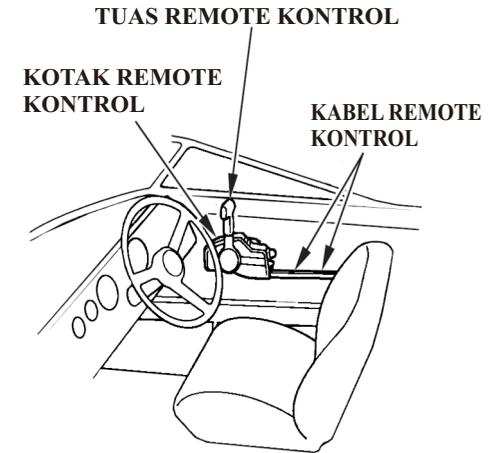
Pasanglah kotak remote kontrol dalam posisi yang memudahkan pengoperasian tuas dan tombol remote kontrol. Pastikan tidak ada hambatan di sepanjang jalur kabel kendali.
